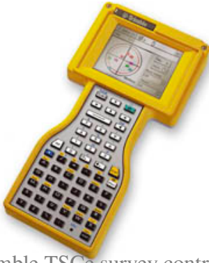
Trimble TSCe survey controller.
