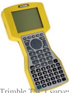
Trimble TSC1 survey controller.
